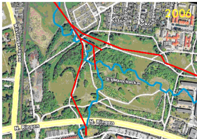
Figur 2. Sankt Hans backar 2006. De två bäckarna (blått) som tidigare genomkorsade området har lagts in i bilden. I rött illustreras dagvattenledningarnas sträckning. Dagvattenledningen österifrån avvattnar Norra Fäläden och den södra ledningen Mölllevången. Bild ursprungligen Melica, 2008b.
