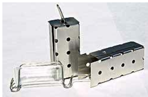
Figur 6. PS Organic, den typ av passiva provtagare som användes vid provtagningen hösten 2008. Bild: ALS Scandinavia AB, 2008b.
